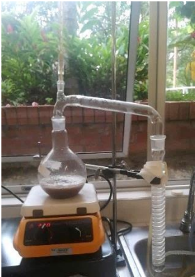
Figura 6. Producción de bioetanol por destilación simple.
