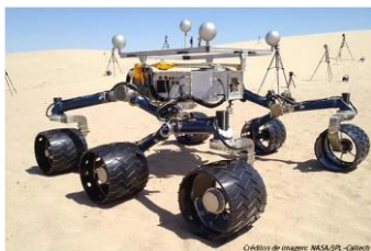
Figura 3. Mecanismo Rocker-bogie usado en el rover Curiosity
